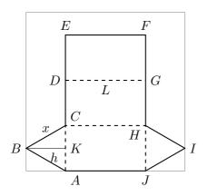
Le patron est construit dans un carton carré de côté  $21\,\mathrm{cm}$ . Les triangles ABC et HIJ sont équilatéraux; les longueurs AC, CD et ED sont égales à BC; les quadrilatères ACHJ, CHGD et DGFE sont des rectangles.
